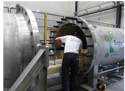
Figure 15 : Plateforme hyperbare permettant de tester des équipements à taille réelle, avec une pression d'eau jusqu'à 40 bars.
