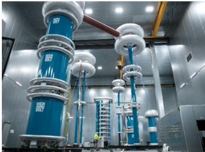
Figure 12 : Plateforme diélectrique haute tension avec des capacités en DC jusqu'à 1200 kV, 20 mA.
