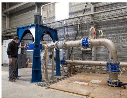
Figure 17 : HydroPHIL permet de simuler les performances de technologies hydrauliques et de nouveaux algorithmes de contrôle (par exemple pour l'hybridation pompe-turbine).
